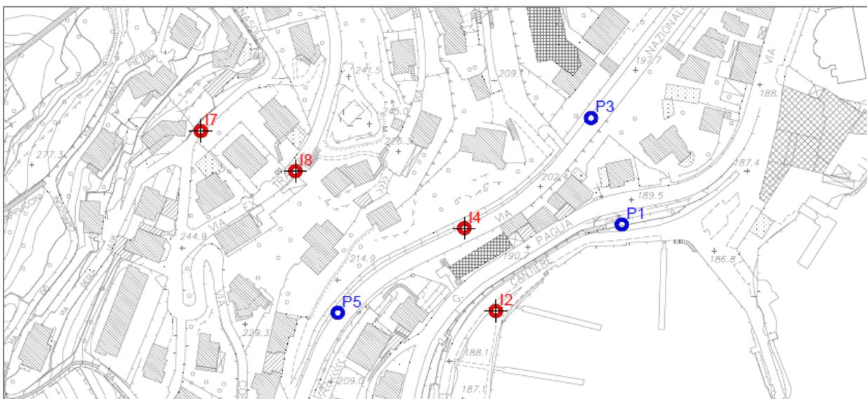
Figura 6.1: Ubicazione verticali inclinometri e piezometriche area di Cornasola
