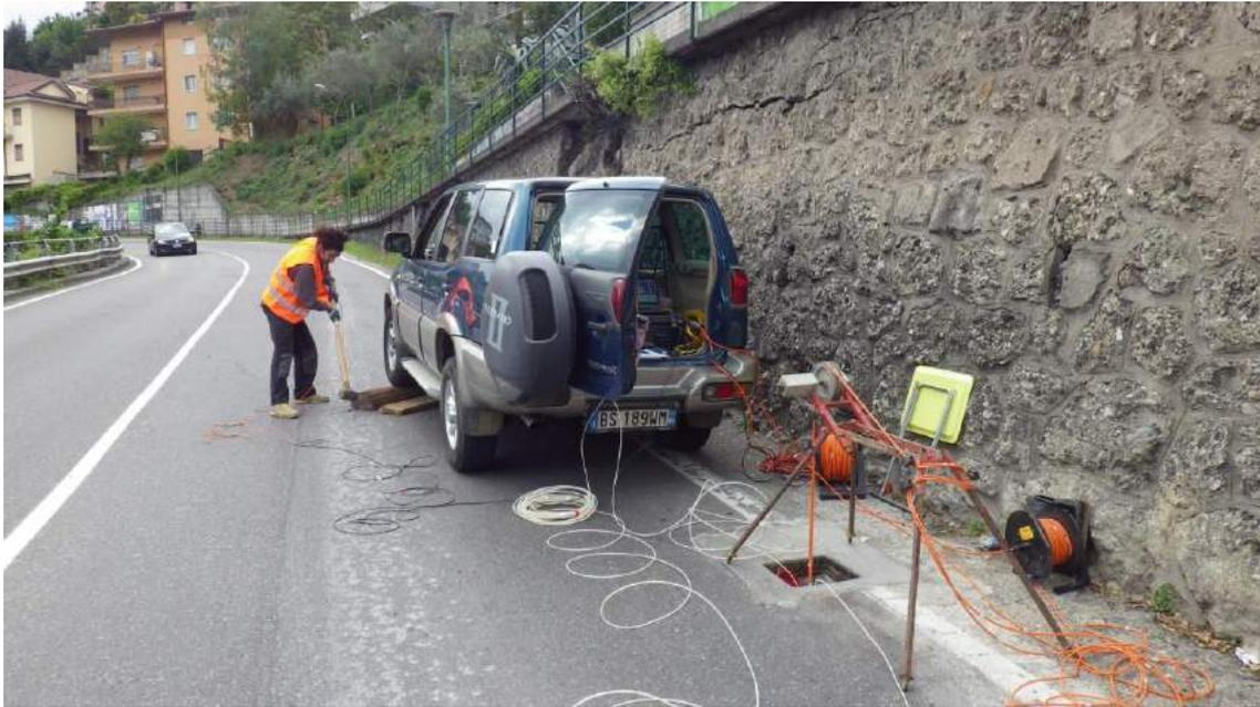
Figura 4: Energizzazione down-hole onde S (DH S06)
