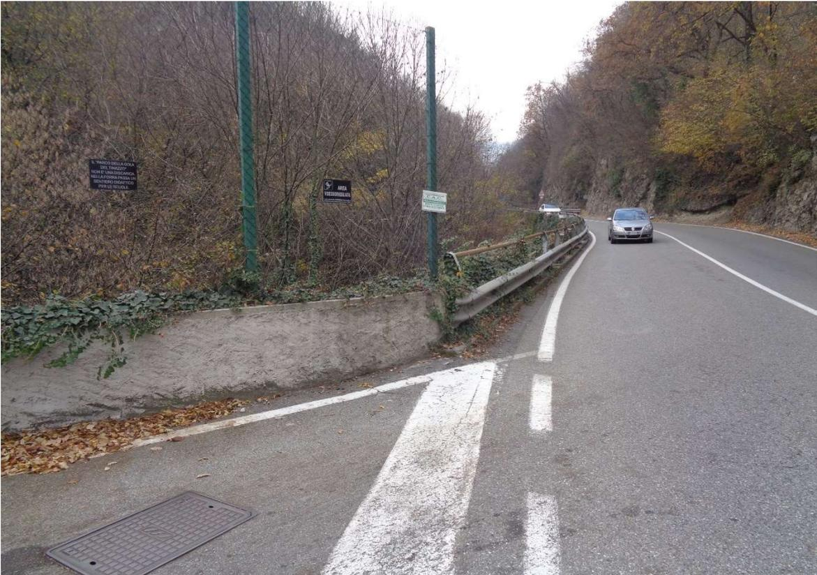
***Percettività 29 – Area della forra fossile – rimozione di tutte le strutture di protezione stradale esistenti, oramai inidonee - nuove murature di contenimento stradale, ancorate con micropali – la pista ritorna di larghezza pari a mt 2.50, fino alla rotonda di Poltragno***
